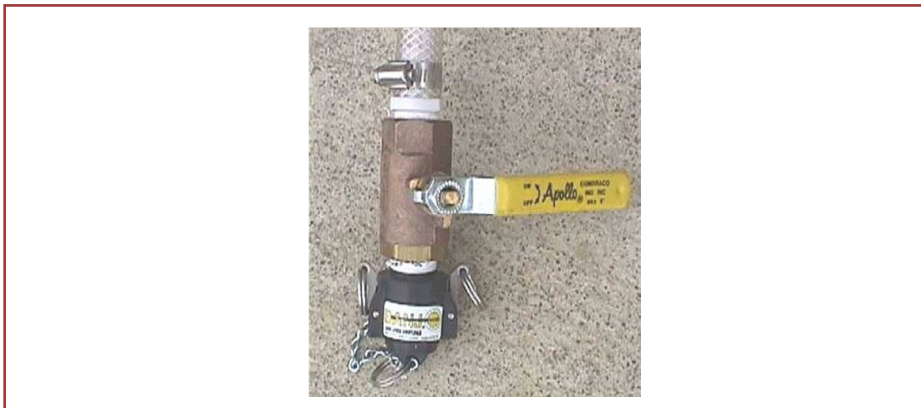
شکل ۸- شیلنگ و شیر توپی برای انتقال آفت کش به سم پاش کوله پشتی
